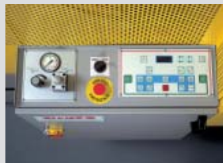
pannello comando automatico plc control panel
